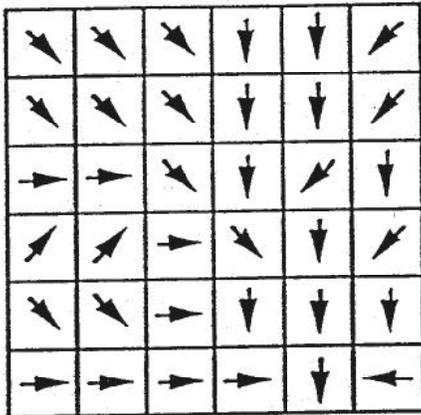
(d) Drainage Network Showing Flowaccumulation
